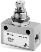
注：控制气缸速度时，建议采用排气节流的方式，即将流量控制阀的 1 口与气缸相连，将流量控制阀的 2 口与方向控制阀的工作口相连。
