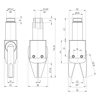
A = Anschlussgewinde B = Befestigungsgewinde
