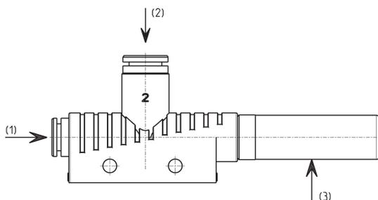
Fluidos utilizables: aire comprimido, lubricado o no, según la norma ISO 8573-1:2001 clase 7-4-4
