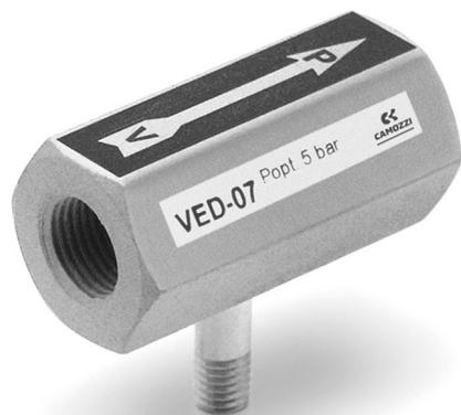
**VED 系列轴向型真空发生器**, 是利用压缩空气的流动而形成一定真空度的气动元件。使用时, 与吸盘和压缩空气源连接, 可减少抽吸量和抽吸时间。
