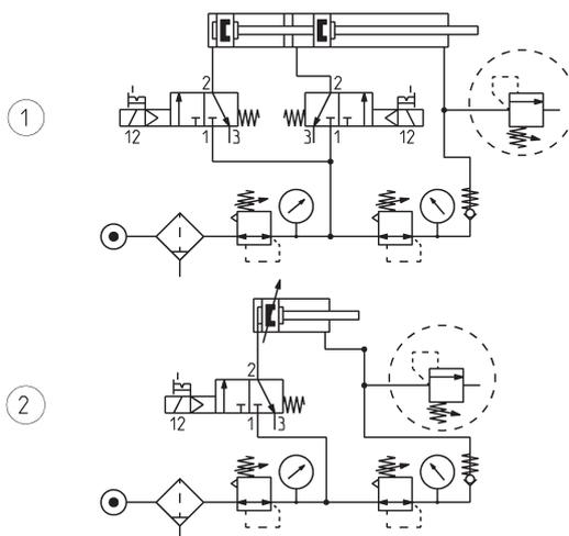
**FONCTIONNEMENT SCHEMA N° 1 :** échappement d'une surpression dans une chambre de vérin ou dans un réservoir lorsque la pression de consigne est dépassée.
