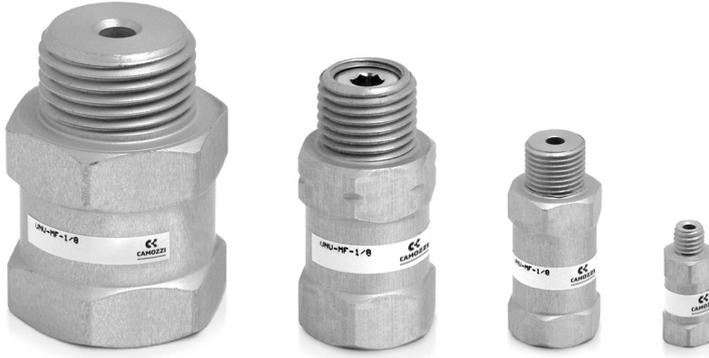
**VNV 系列止回阀**用于真空抓取系统中多吸盘的应用场合,可防止未接触工件的吸盘或突然脱离工件的吸盘对系统造成的影响,保证系统所需的真空度。
