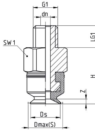
Toleranzen der Abmessungen für Gummitteile entsprechend DIN ISO 3302-1 E3
