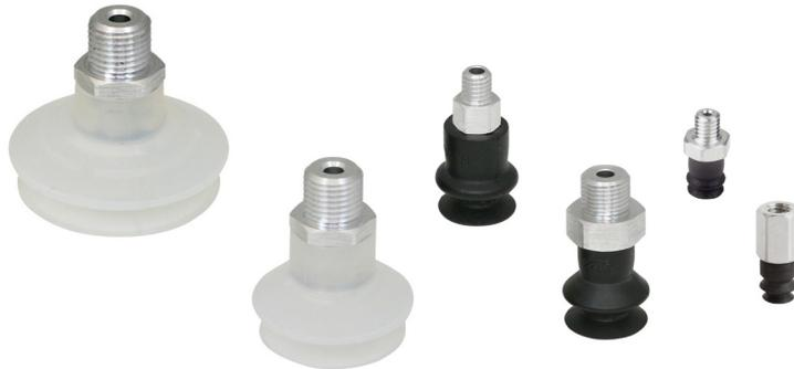
Die Balgsauggreifer der Serie VTCL verfügen über eine robuste Bauweise mit Anschlussnippel und Gummiformteil. Die Anschlussnippel sind direkt in das Gummiformteil eingebracht. Diese Sauggreifer können als Verschleißteile ohne Nippel bestellt werden.
