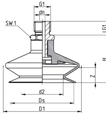
Toleranzen der Abmessungen für Gummiteile entsprechend DIN ISO 3302-1 M3
