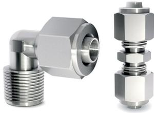
Les raccords à olive Série X1000 peuvent être facilement installés. Les écrous de blocage peuvent être serrés manuellement et avec une clé, même dans le cas de tubes plus rigides comme le PA ou l'Hytrek Polyester. La forme du cône de guidage spécial garantit que le tube ne peut pas être coupé accidentellement.
