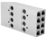
注：90° 转角气路板用于将原来底面出口 (2-4 口) 旋转 90°，变为端面出口。
