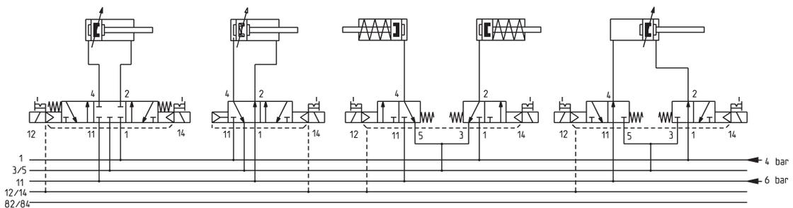
**Ventilinsel mit Einzelanschluss - Mod. YP1K-...**
