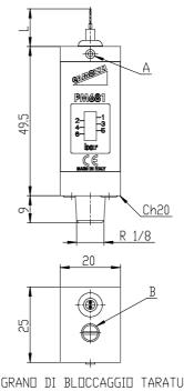
A= GRAND DI BLOCCAGGIO TARATURA B= GRAND DI REGOLAZIONE
