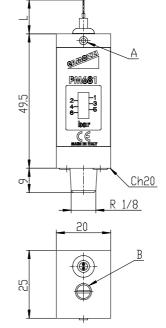
A= GRANO DI BLOCCAGGIO TARATURA B= GRANO DI REGOLAZIONE
