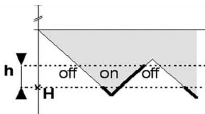
I due valori che caratterizzano il funzionamento dello switch sono detti "Punto di commutazione H" (es. -0,60 bar) e "Campo di isteresi h" (es. 0,15 bar). In caso di settaggio "NO" (Normally Open), a 0 bar non ha nessun segnale in uscita.
