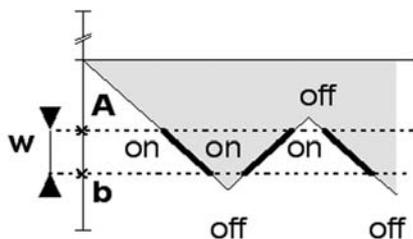
I due valori che caratterizzano il funzionamento dello switch sono detti "Valore di base A" (es. -0,45 bar) e "Valore di punta b" (es. -0,60 bar). In caso di settaggio "NO" (Normally Open), a 0 bar non ha nessun segnale in uscita.
