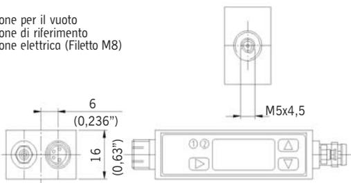
Se l'interruttore viene impiegato in un ambiente umido, l'attacco di riferimento (per la pressione ambientale o di riferimento) deve essere collegato a un tubo di sfiato ( $\phi$  3 mm) che termina in un ambiente secco.
