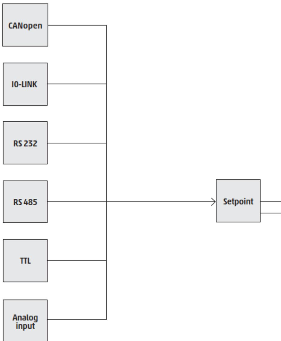
Figura 3.2: Struttura di controllo per l'acquisizione del setpoint
