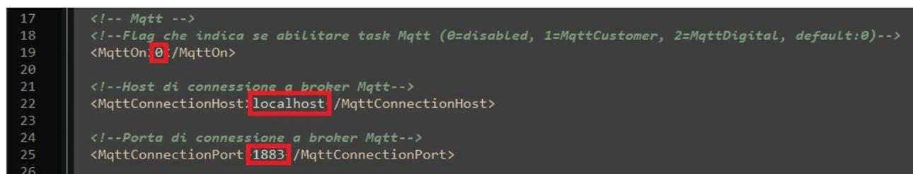
Figura 3.8: Modifica della porta Web Service - MQTT for external application
