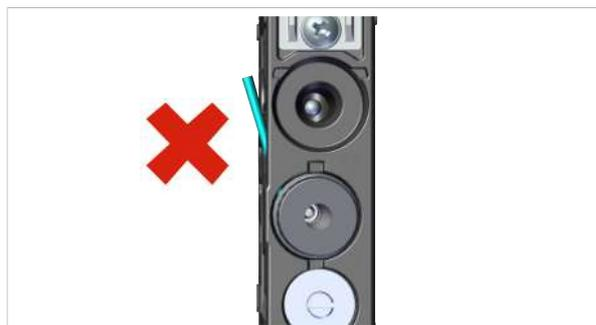
7. Provare la tenuta sicura del silenziatore, tirando l'alloggiamento (fisso).
