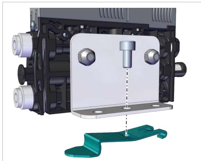
3. Colocar el módulo con la fijación en contacto con el raíl DIN ① y presionar ②.
