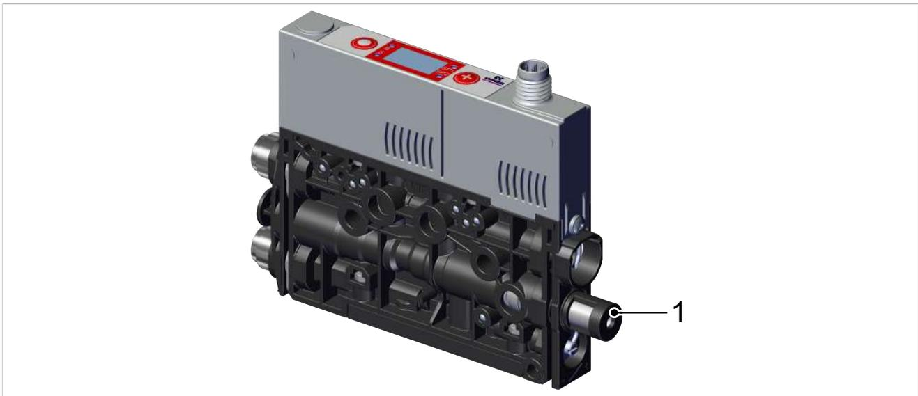
Bei der Montage des Ejektors gewährleisten, dass der Bereich rund um den Schalldämpfer (1) frei bleibt, so dass die ungehinderte Abführung der ausströmenden Luft sichergestellt ist.
