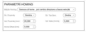
Il motore gira finché non viene raggiunto il segnale di zero dell'encoder; il senso di rotazione durante questa procedura dipende dalla scelta effettuata nella finestra seguente:
