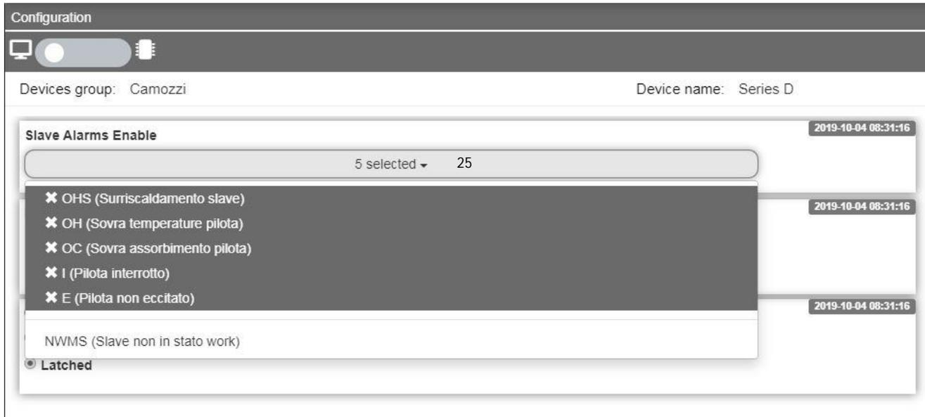
Cliccando sul menu' a tendina (25) è possibile abilitare o disabilitare il singolo allarme per la sottobase in configurazione. In caso si presenti uno degli eventi per cui è stato abilitato l'allarme viene inviata una segnalazione di errore.
