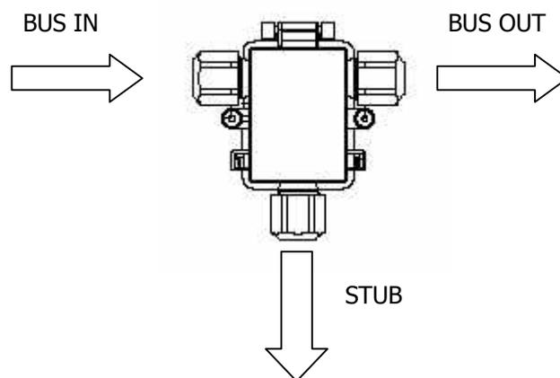
La derivazione a T per la linea DeviceNet deve essere posizionata il più vicino possibile all'isola di valvole Serie Y in modo da limitare la lunghezza dello stub.
