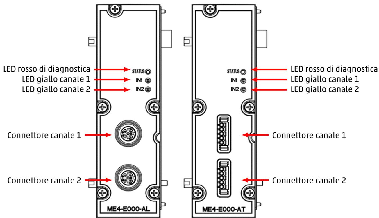
**N.B.** Le diverse tipologie di moduli di ingressi analogici hanno piedinature specifiche e dedicate alle loro funzionalità. La segnalazione visiva del funzionamento e della diagnostica avviene mediante tre LED.
