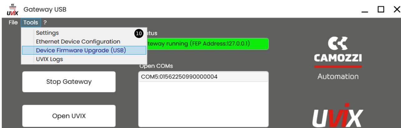
La finestra per aggiornare il firmware indica la versione attuale <sup>11</sup> e permette di selezionare il nuovo eseguibile da caricare nel modulo <sup>12</sup>. Il nome dell'eseguibile da caricare deve avere la seguente nomenclatura:
